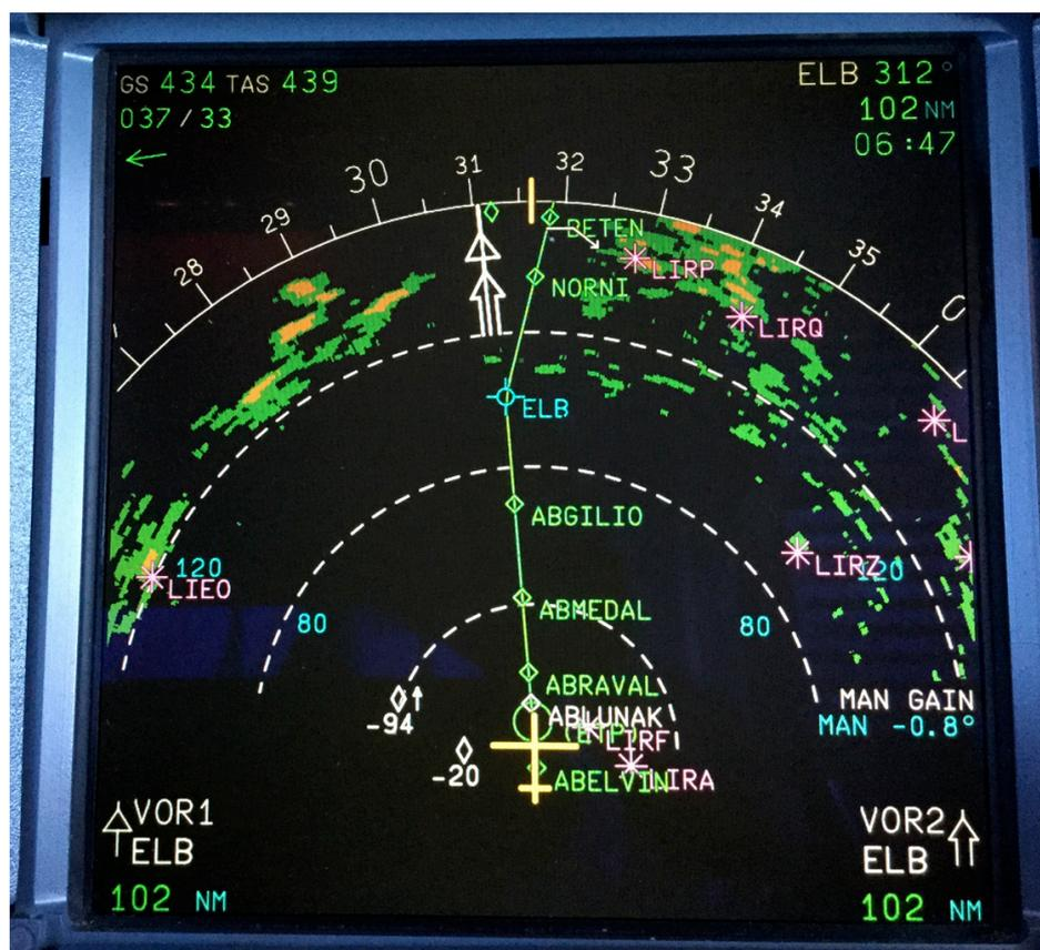
Figura 2: navigation display di un A320 inquadrato da una telecamera.
