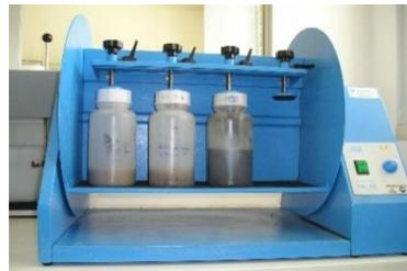
Valutazione, mediante test di cessione, del rilascio di inquinanti dai rifiuti testati e dai materiali ottenuti dal **RECUPERO** di rifiuti.
