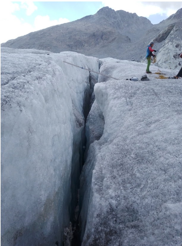
L'installazione di un sensore geo-acustico in un crepaccio del Ghiacciaio dell'Adamello, 2022.
