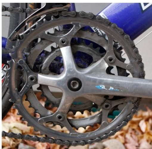
*Figura 4 – esempio di pedivelle con integrato il collegamento alla corona (in questo caso a cinque fori).*
